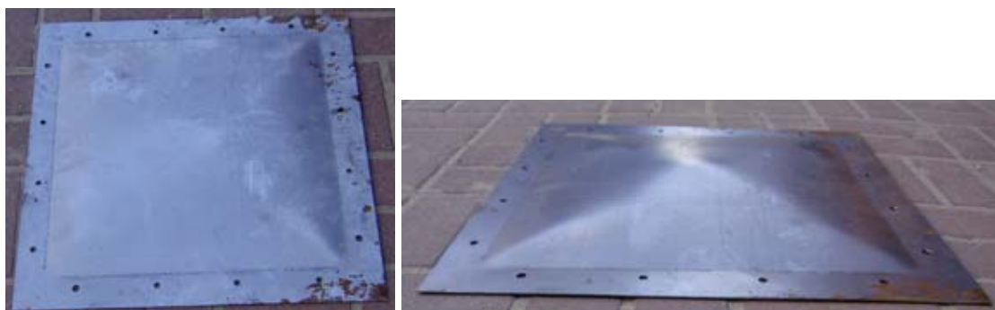
Rys. 8. Obiekt 1 blacha o grubości 1.5 mm, deformacja uzyskana z eksperymentu Fig. 8. Object 1 – sheet 1.5 mm thick, deformation obtained experimentally
