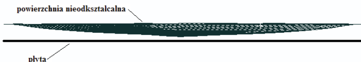
Rys. 11. Model służący do określenia energii odkształcenia Fig. 11. Model for determining the energy of deformation
